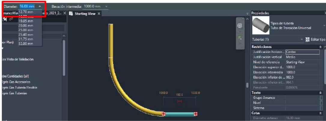
Una vez realizado el cambio de tubería y de diámetro al tubo de transición, observaremos que se ha insertado de manera automática un cople reducción al final de la tubería flexible.
