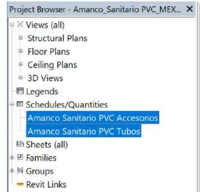
En las Tablas de cantidades de Tuberías se encuentran clasificadas según su diámetro y la longitud total por cada diámetro. Si necesita conocer las **longitudes individuales** de cada tubería y no la longitud sumada por diámetro, vaya al área de *Propiedades*, en la sección de *Otros* encontrará *Clasificación/Agrupación* y de clic en *Editar*. Al abrirse el panel de propiedades de la tabla puede activar la casilla “**Detallar cada ejemplar**” para ver las tuberías individualmente.
