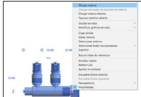
2. Use la herramienta “Alinear” (AL) para alinear el Manifold a una tubería. Seleccione el centro del accesorio y del extremo de la tubería.
