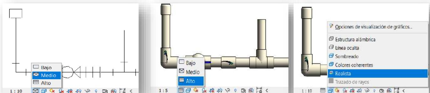
Adicional, se recomienda configurar las unidades del proyecto en la pestaña “Gestionar”, debe buscar “**Tamaño de Tubería**” (Si es Revit en inglés **Pipe Size**) en pulgadas como se muestra en las siguientes imágenes.
