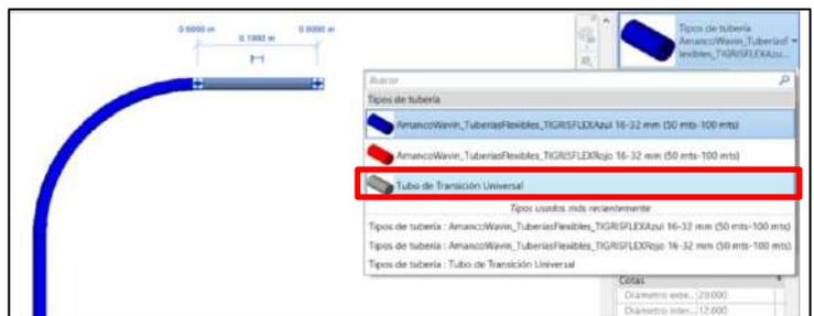
2. Seleccionaremos el tramo recto restante y es el que vamos a cambiar por el tubo de transición universal. **Nota: Siempre se debe cambiar el diámetro del tubo de transición universal a un diámetro inferior al de la tubería Tigris Flex ya dibujada.**
