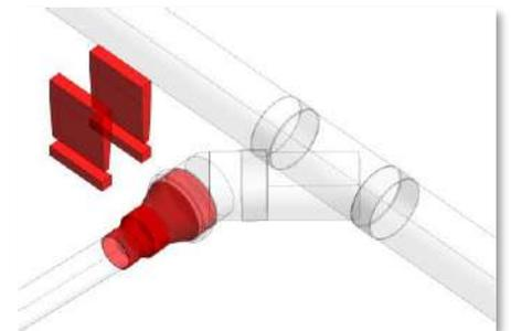
Las conexiones a 90° en el sistema sanitario son cargados de manera predeterminada como una Ye + codo 45°, si se desea cambiar por una Tee 90° siga los pasos mostrados anteriormente.
