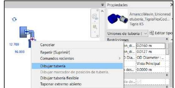
4. Use la herramienta “Alinear” (AL) para alinear el Accesorio Roscado a una tubería. Seleccione el centro del accesorio y del extremo de la tubería. Una vez que el accesorio quede alineado a la tubería, debe seleccionar la tubería para que aparezca el conector de a tubería y dar clic en el hasta que aparezca un cuadro morado, esto significa que la tubería quedo conectada al accesorio.
