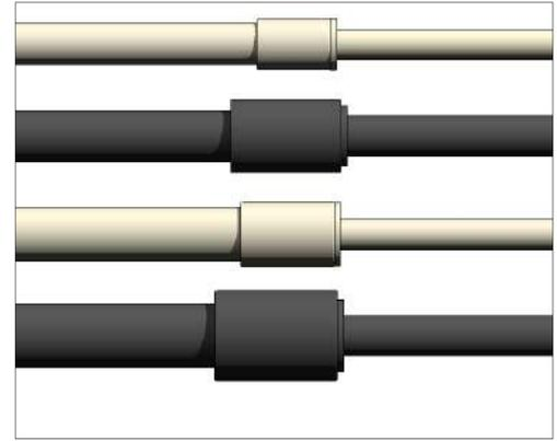
En la línea CPVC Cédula 80 es posible reemplazar la Reducción Bushing por una Reducción Bushing Cem –RH, seleccione la Reducción Bushing que se inserta predeterminadamente y diríjase al área “Propiedades” y active la casilla “Bushing Campana- Rosca Ced80” .
