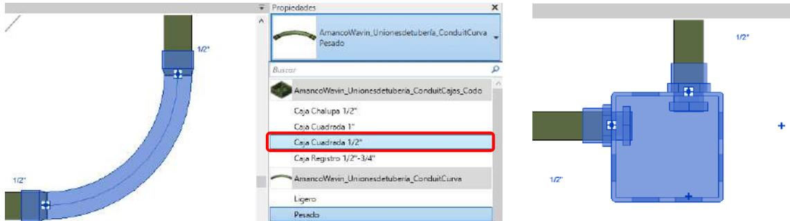
Si desea una **caja registro** con cambio de diámetro deberá conectar un tubo de ½" o ¾" a 90° antes de elegir la caja. Una vez se haya insertado un codo, ahora deberá cambiarlo en el apartado de propiedades y seleccionar la **Caja Registro de ½" - ¾"**. Después lo único que debe hacer es cambiar el diámetro del tubo que desee. Esta transición sólo se podrá realizar con la caja registro de ½" - ¾".
