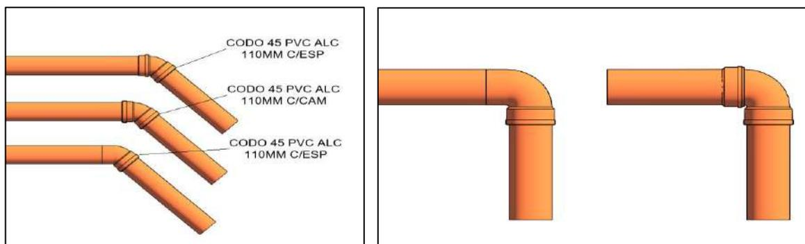
**Nota:** Revisar los codos disponibles según los diámetros y tipo de tubería. (Ver 10.2)
