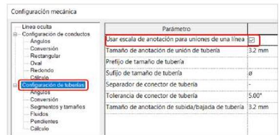
Es necesario activar este parámetro antes de empezar a trazar los sistemas. De no ser activado desde el comienzo se deben seleccionar todos las Uniones de tubería (Pipe Fittings) que se han dibujado en el proyecto y en el area de Propiedades activar la casilla “Usar escala de anotación”:
