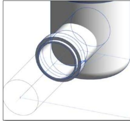
2. Use la herramienta "Alinear" (AL) para alinear el Cespól a una tubería. Seleccione el centro del accesorio y del extremo de la tubería.
