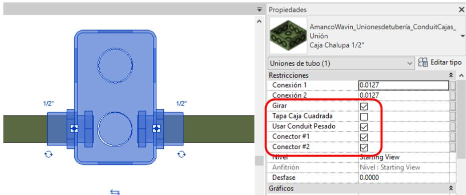
Cada vez que una caja unión es usada, se pueden insertar los Conectores según los puertos que se deseen, al seleccionar la caja y activar estas casillas en el área de Propiedades. Dependiendo del diámetro de los tubos y del tipo de caja la orientación de estas puede variar.
