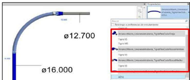
Una vez realizado el cambio de tubería y de diámetro al tubo de transición, observaremos que se ha insertado de manera automática un cople reducción al final de la tubería flexible.
