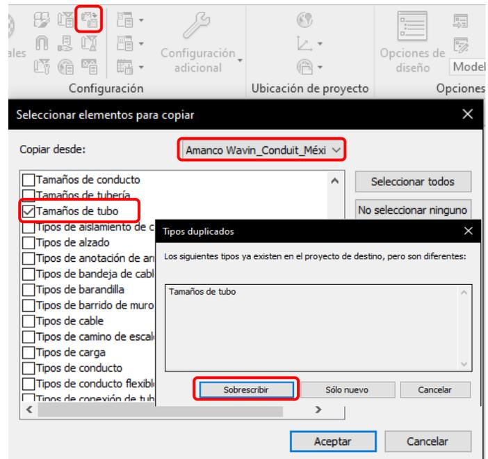
**Caso 2:** En el proyecto/plantilla donde va a importar las librerías si se han creado o modificado los tamaños de tubo en la configuración eléctrica de Revit.
