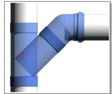
**⚠** En los diámetros en los cuales no existe codo a 45° Anger, automáticamente aparecerá una Tee a 90° Cementar.
