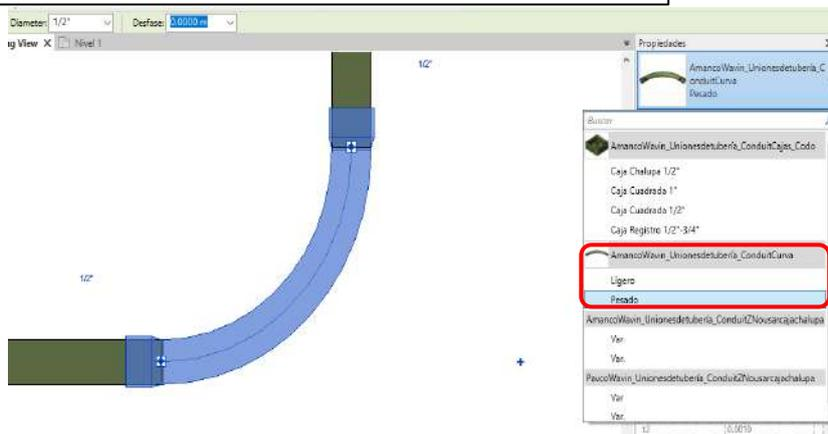
**Nota:** Las conexiones y/o accesorios serán los mismos para Conduit Tubo Pesado y Conduit Tubo TP. Mientras que Conduit Tubo Ligero tendrá sus propios accesorios y/o conexiones. Puedes definir de qué línea corresponde dentro de las propiedades de cada Familia que utilices, seleccionando la casilla "Usar Conduit Pesado" si ocuparás cualquiera de las dos líneas antes mencionadas.
