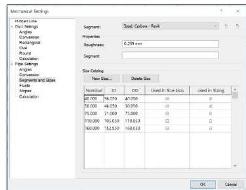
Usa diámetros y longitudes de tubería disponibles en un portafolio de productos específico.
